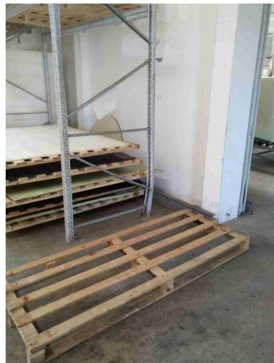
I montanti frontali delle scaffalature urtabili dai carrelli elevatori o altri mezzi sono dotati di paracolpi?
