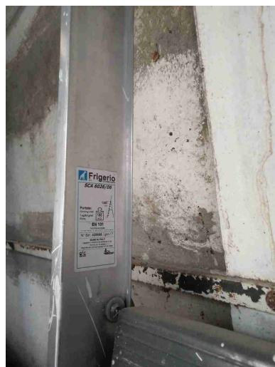
Le scale portatili utilizzate per lavori elettrici sono di un materiale dielettrico?
